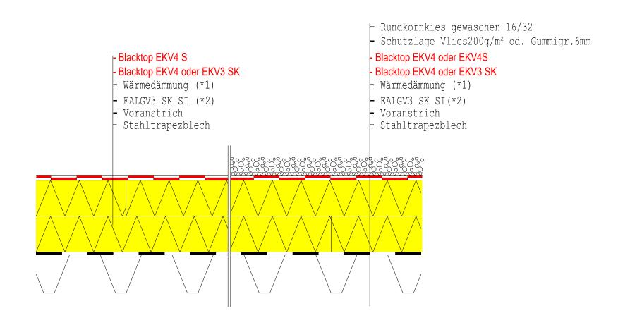
(\*1) Wärmedämmung entsprechend druckfest,
