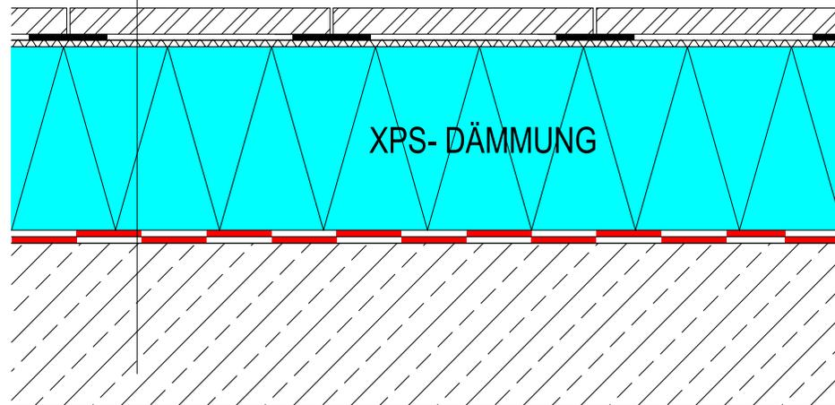
(\*1) Wärmedämmung XPS entsprechend druckfest
