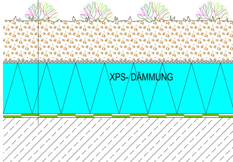
(\*1) Wärmedämmung XPS entsprechend druckfest,
