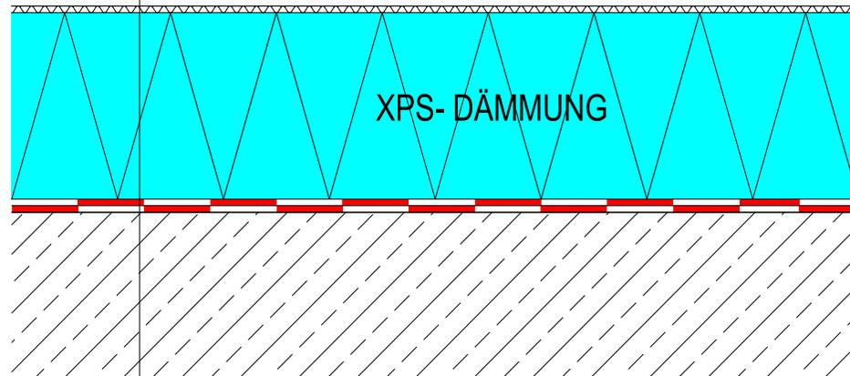
(\*1) Wärmedämmung XPS entsprechend druckfest
